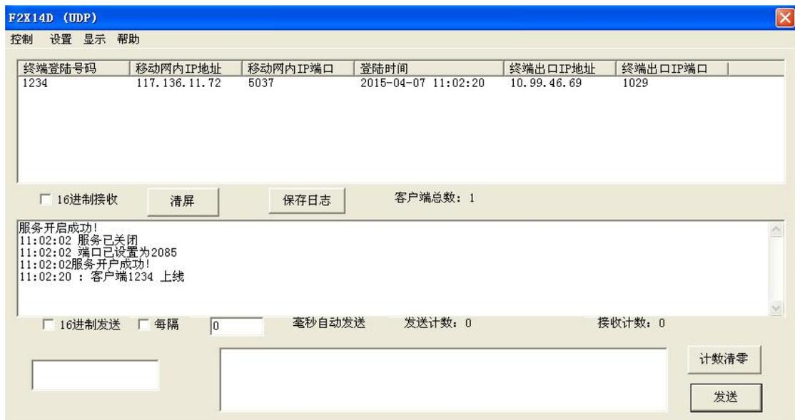
4、现在就可以测试 F2X14-E 与数据中心之间的通信，数据中心接收到的数据将显示在信息窗口，数据中心发送的数据将被远端设备接收。在这里，我们用的是一台电脑通过串口与 F2X14-E 连接来模拟远端设备（可以用超级终端或其他终端软件，在这里我们用的是一款串口工具）访问 F2X14-E 串口。
