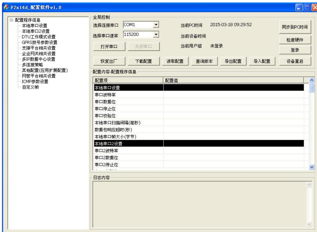
打开配置软件，选择正确的串口参数后，先进行硬件检测，当检测到硬件正常后点击登录对话框，要求用户输入用户名和密码，如图：
